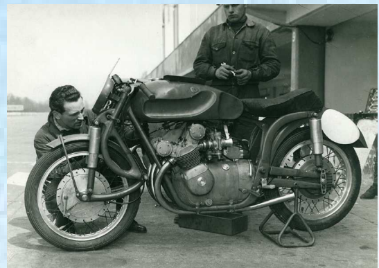
MV 500 4 cilindri "Cardano" - 1952 con forcella "Earles"
