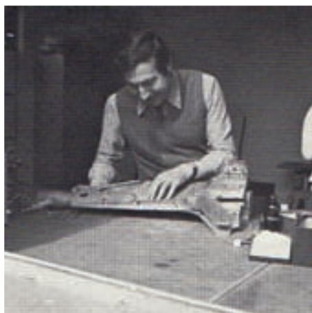
L'applicazione della strumentazione (strain gauges) a uno spezzone di pala del rotore di coda
